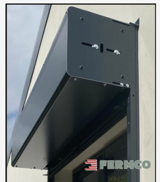
Coffre en tôle pliée aluminium d'une épaisseur de 15/10e à pans arrondies en 2 faces.
